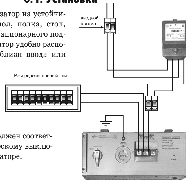
Рис. 10. Схема установки стабилизатора
